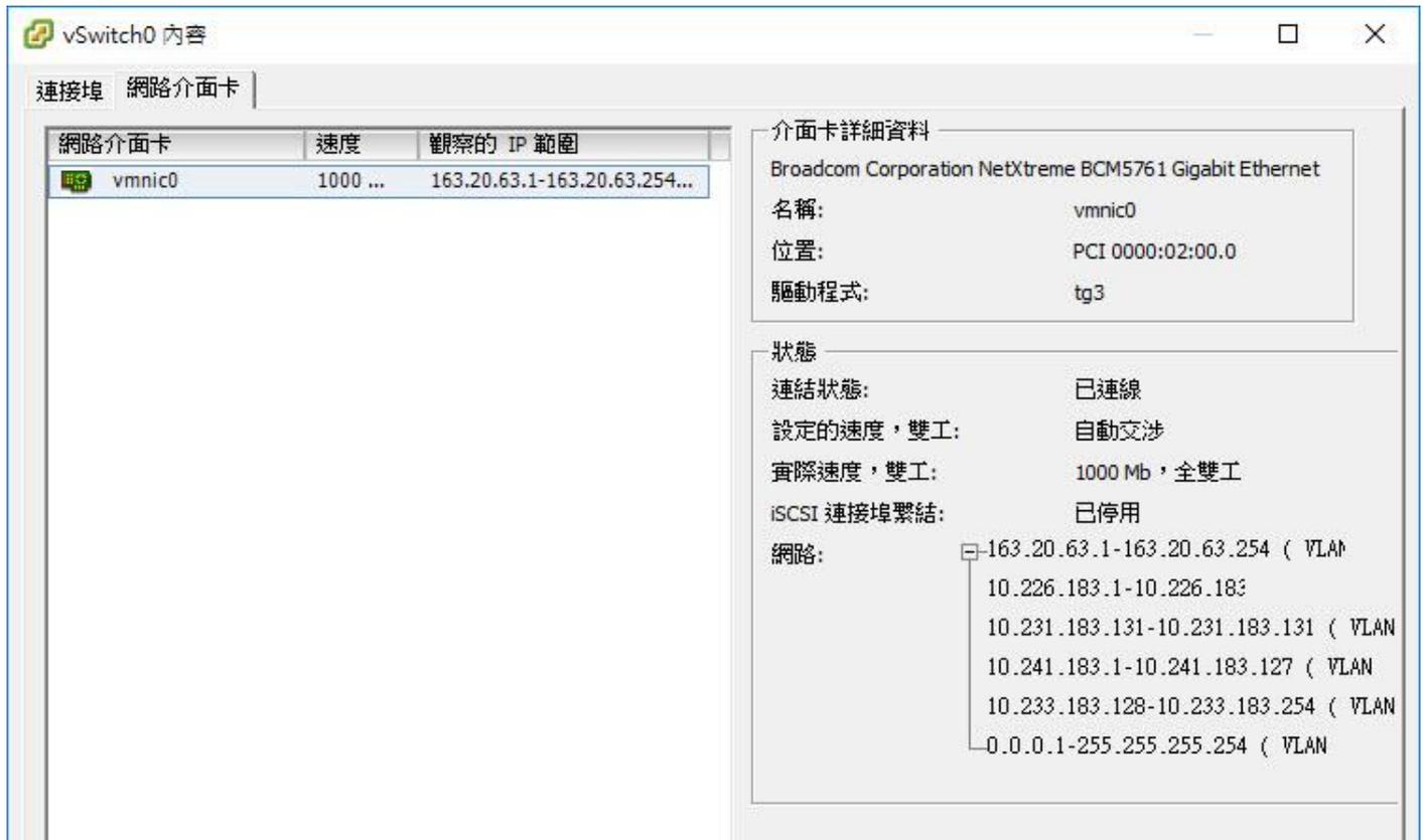
點選 VM Network 虛擬連接埠，現 VLAN ID 現為 0，所以會造成使用該連接埠的虛擬機無法對外連線，所以必需將虛擬連接埠 VLAN 識別碼設定成實體交換器上存在的 ID，才能讓該虛擬連接埠正常連線。
