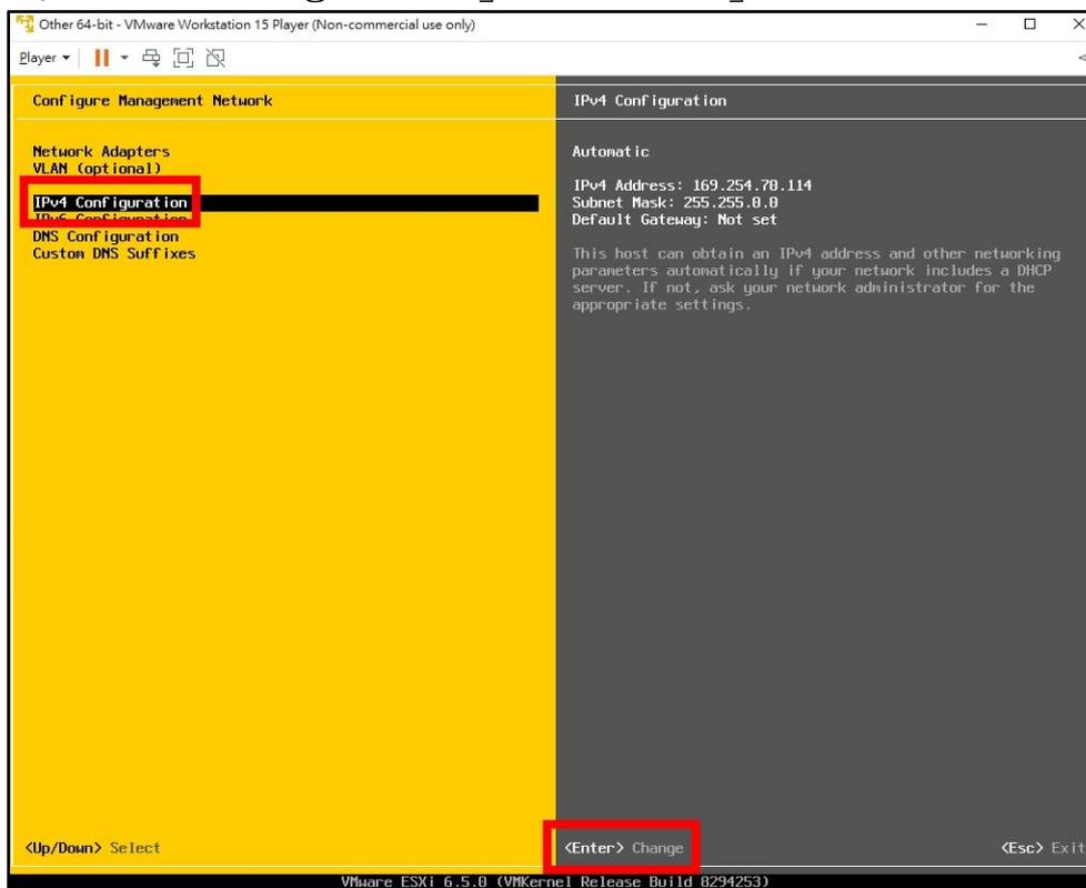
33. 上下鍵移動，按空白鍵選擇「Set static IPv4 address and network configuration」
