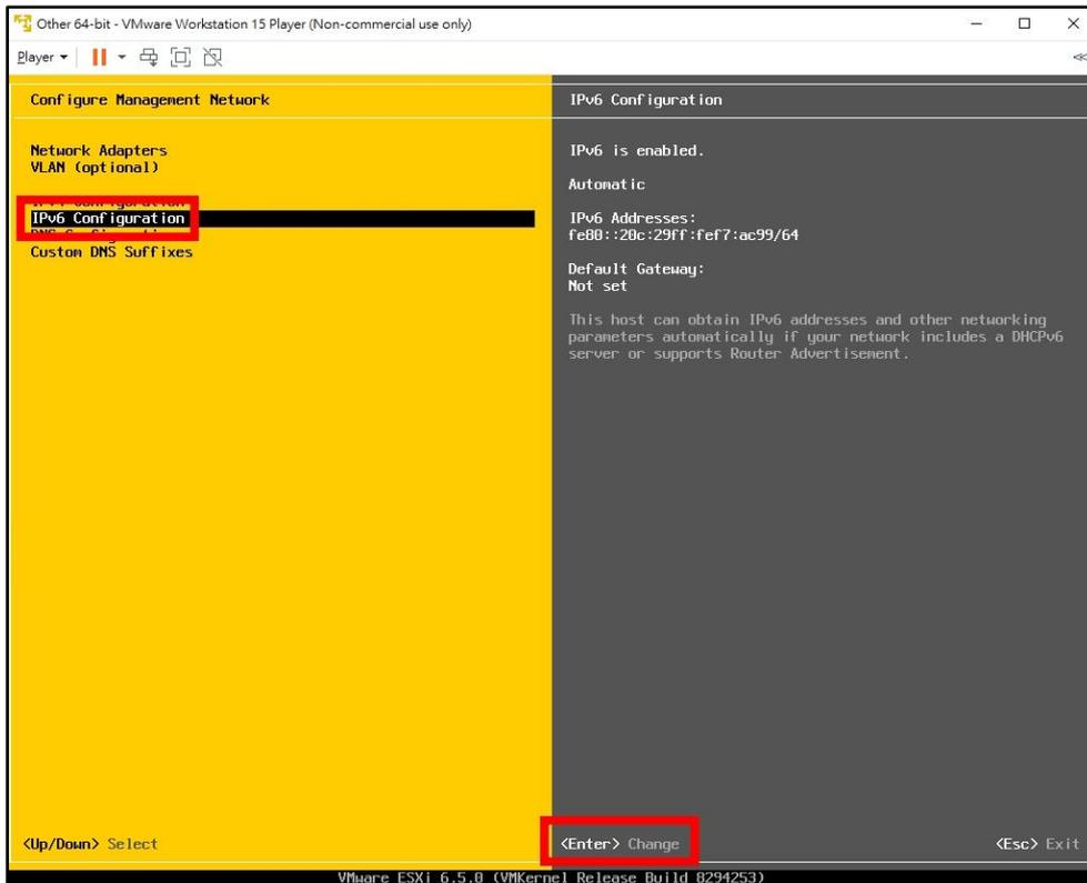
35. 上下鍵移動，按空白鍵選擇「Set static IPv6 address and network configuration」，輸入研習配發之 IPv6 位址，請記得最後要加上「/64」子網路遮罩，輸入完成按「Enter」
