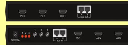
三組HDMI影像輸入/輸出埠，一組 BUS輸入/輸出埠；傳輸線材採用Cat. 6線材。
