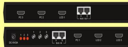
三組HDMI影像輸入/輸出埠，一組 BUS輸入/輸出埠；傳輸線材採用Cat. 6線材。
