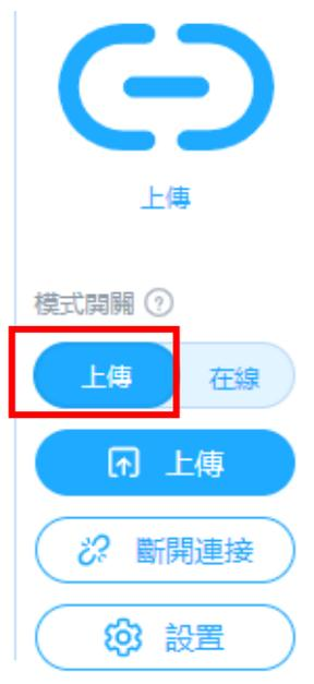
適合成品和物聯網展示用，即為離線模式，將撰寫好的程式上傳至控制板中。
